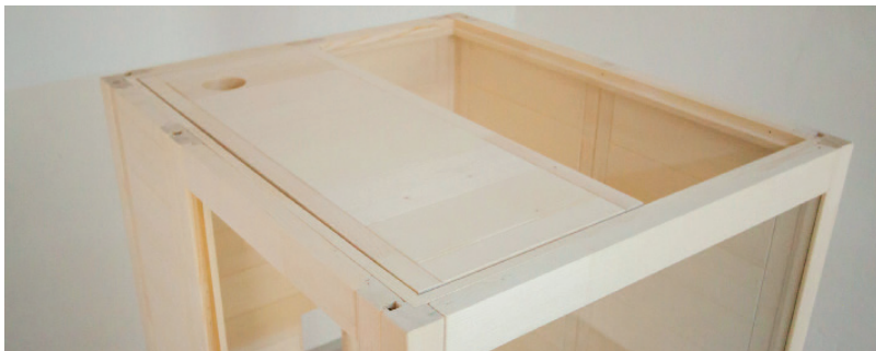
Fig. 14 : Insertion de l'élément de toit avant
