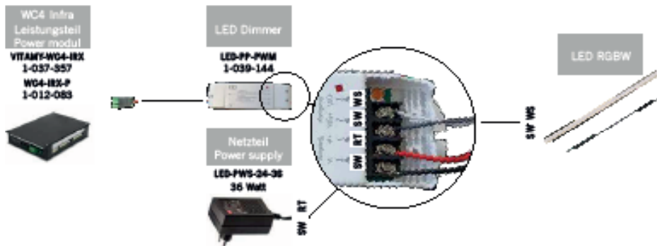
Fig. 28: Conexão da tira LED ao comando
