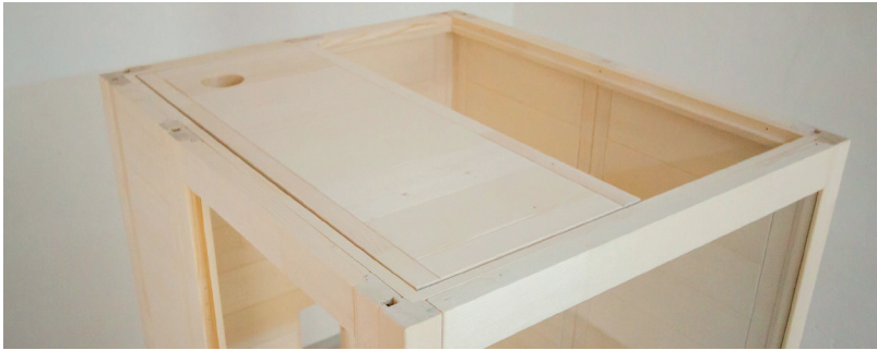
Abb. 14: Einlegen Dachelemente vorne
